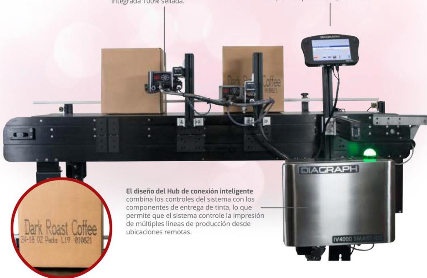
**El diseño del Hub de conexión inteligente** combina los controles del sistema con los componentes de entrega de tinta, lo que permite que el sistema controle la impresión de múltiples líneas de producción desde ubicaciones remotas.
